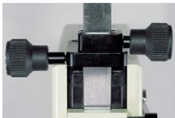
Abb. 27: Der Tiefenanschlag wird justiert.
