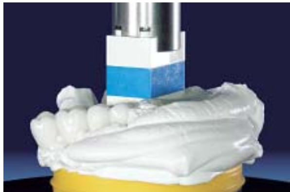
Abb. 30 - 32: Beim Aufgipsen ist zu beachten, daß sich die Passung der Steckbausteine nicht verändert und so die fehlerfreie Ausrichtung der Schablone nach dem Referenzobjekt erhalten bleibt.
