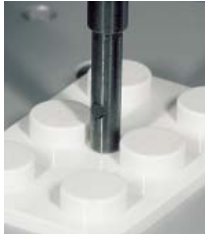
Abb. 36: Auch der Halter für die Bohrhülsen wird zunächst wieder in der Ausgangslage auf die Länge justiert.
