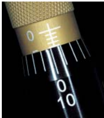
Abb. 34: Die im Datenblatt ausgewiesenen „Koordinaten“ werden an jedem der sechs Beine des Hexapods präzise eingestellt.
