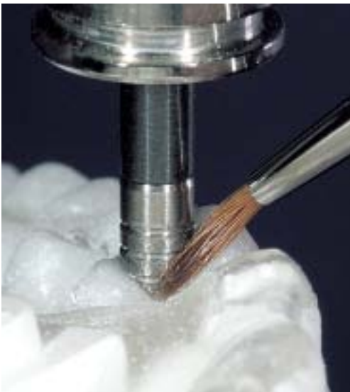
Abb. 38 und 39: Die Bohrhülse wird mit lichthärtendem Kunststoff in die Bohrung eingeklebt, der Überschuß entfernt und ausgehärtet.
