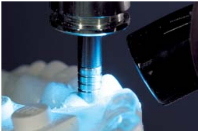
Abb. 38 und 39: Die Bohrhülse wird mit lichthärtendem Kunststoff in die Bohrung eingeklebt, der Überschuß entfernt und ausgehärtet.
