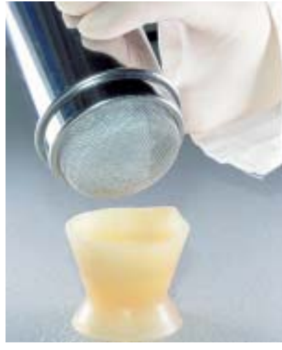
Abb. 7: Bariumsulfat wird durch ein Sieb gegeben, um Klumpenbildung zu vermeiden.
