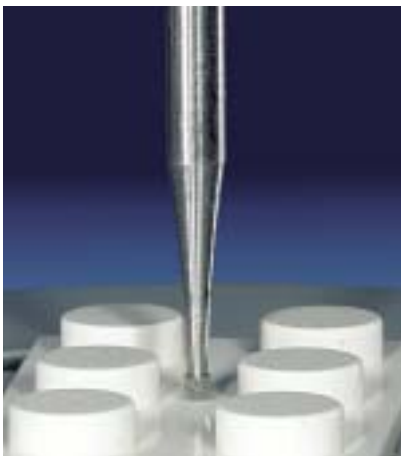
Abb. 33: Der Anschlag für die Bohrtiefe wird bestimmt.
